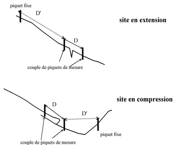
Figure 6. Processus et dispositif de mesure de la solifluxion lente
