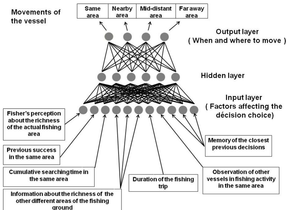
Réseau de neurones artificiels utilisé pour simuler la prise de décision du pêcheur vis-à-vis d'un changement de zone de pêche (d'après Dreyfus et Gaertner (2006), *Ecological Modelling* 195: 30-36).
