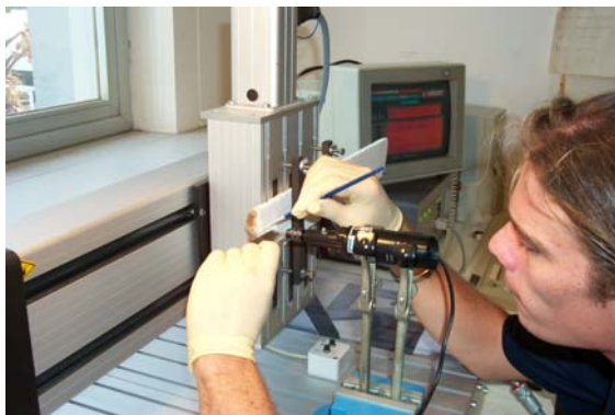
Figure 2.5 Appareil de micro échantillonnage. La plaque de corail vient au contact de la mèche selon les paramètres rentrés dans le programme (ordinateur au deuxième plan).
