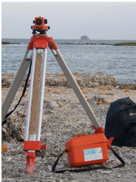
Photographie 4 : Relevé topographique au theodolite (crédit photo Timothée Ourbak).
