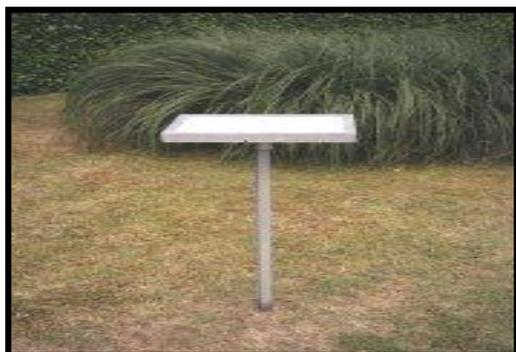
Photo 27. Glêlimètre en place (Source : [www.anelfa.asso.fr](http://www.anelfa.asso.fr))
