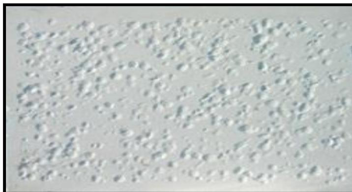
Photo 29. Dépouillement par scanner des diamètres des Grêlons (Source : [www.anelfa.asso.fr](http://www.anelfa.asso.fr)).
