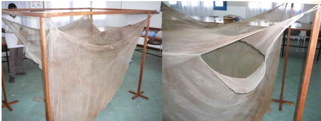
Figure 1. Moustiquaires usagées installées sur un cadre pour le comptage et l'évaluation de la taille des trous.
