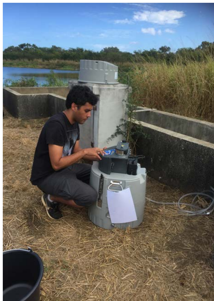
Programmation du préleveur automatique d'eau à l'entrée d'un système d'assainissement d'eaux usées (c) IPNC-M. KAINIU
