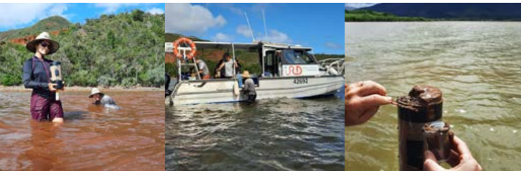
Tryptique « du carottage au découpage » : (a) Carottage des sédiments dans l'estuaire de la rivière des Pirogues. (b) Ce travail a été réalisé avec les moyens navigants de l'IRD. (c) Collecte du sédiment de surface.
