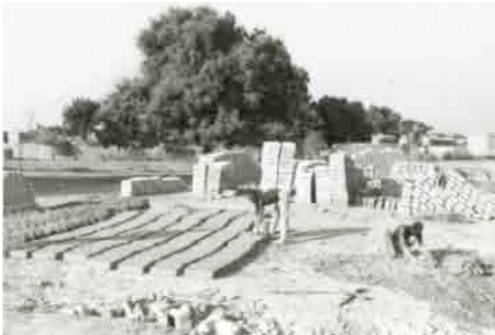
Photo n° 5 : la fabrication des briques (De la droite vers la gauche : malaxage, moulage, séchage, stockage)
