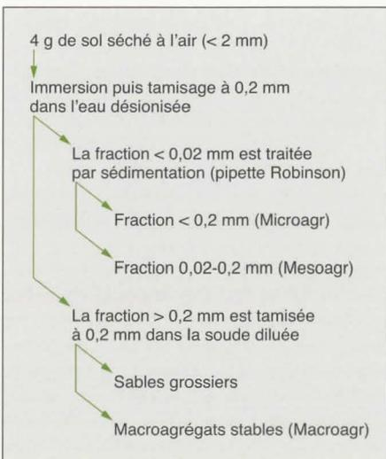
Figure 1. Description schématique du test de stabilité structurale.
