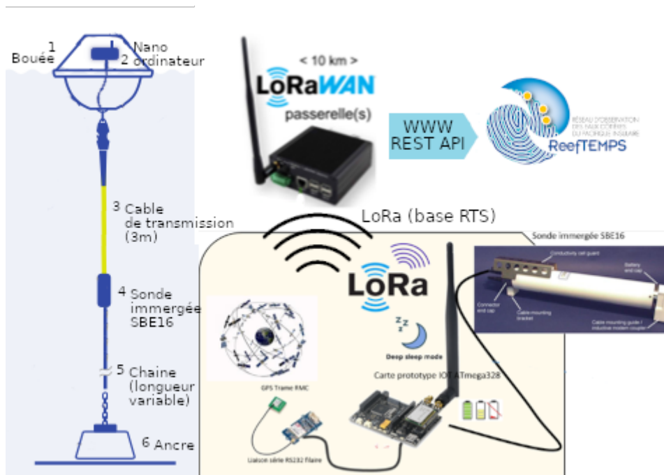
Figure 1 - Schéma du prototype - à gauche, le schéma de montage du prototype, en bas, le détail des appareils mis en œuvre et en haut les protocoles d'envoi des données du réseau LoRa vers base de données océanographique du SNO ReefTEMPS.
