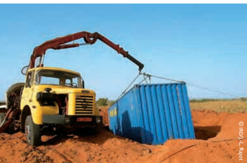
Conteneur-laboratoire pour la mesure des poussières éoliennes, Niger.
