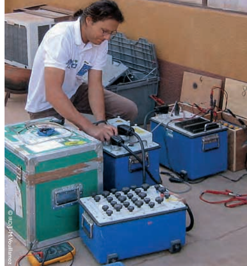
Prospection aquifère par résonance magnétique.
