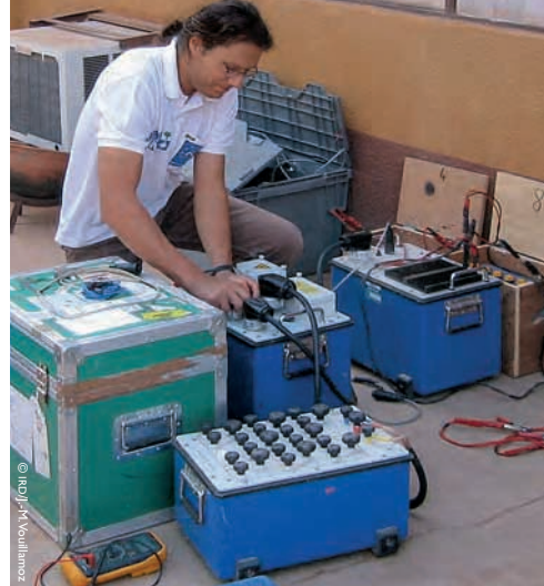
Prospection aquifère par résonance magnétique.
