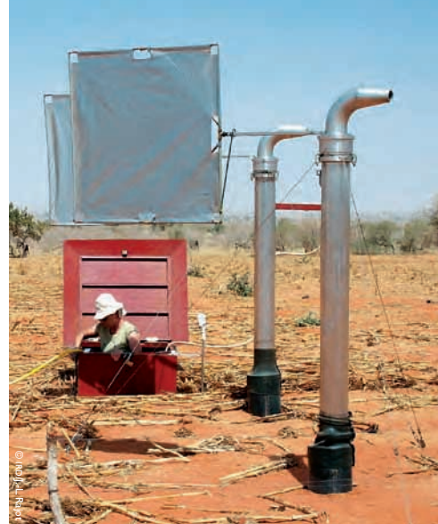
Mesure des poussières éoliennes, Niger.
