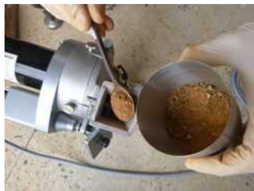
d) Alimentation du broyeur
