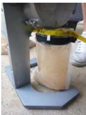
e) Récupération du matériel broyé
