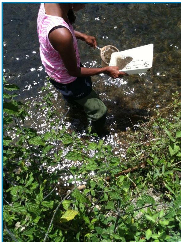
Élutriation d'un prélèvement unitaire réalisé sur du sable au moyen d'un filet à main de même maille que le Surber.
