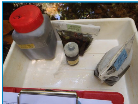
Exemples de conditionnement des prélèvements unitaires (utilisation de sachets et/ou de flacons de conditionnement)
