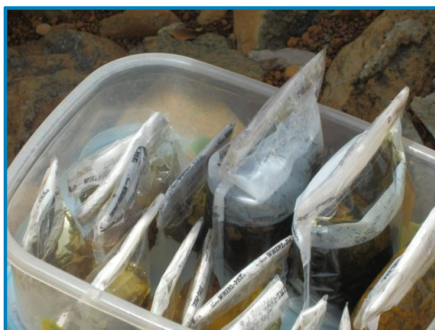
Exemples de conditionnement des prélèvements unitaires (utilisation de sachets et/ou de flacons de conditionnement)
