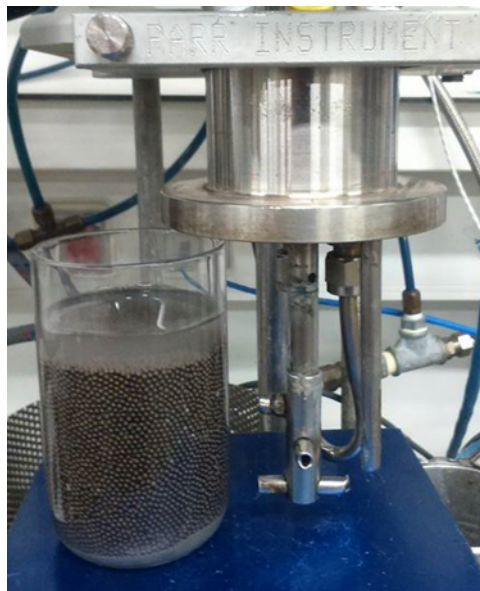
Figure 5 : Réacteur d'attrition (corps broyant = billes en inox)
