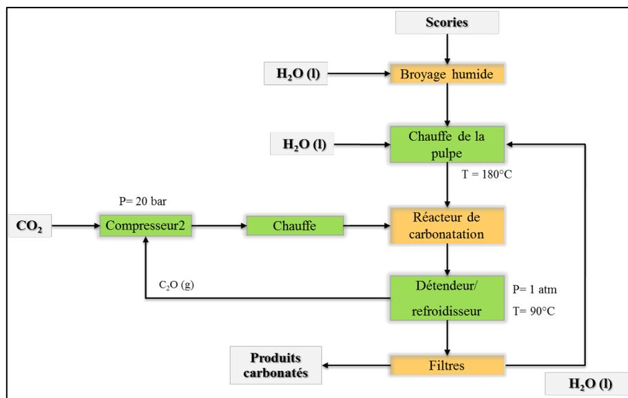
Figure 7 : schéma du procédé de carbonatation
