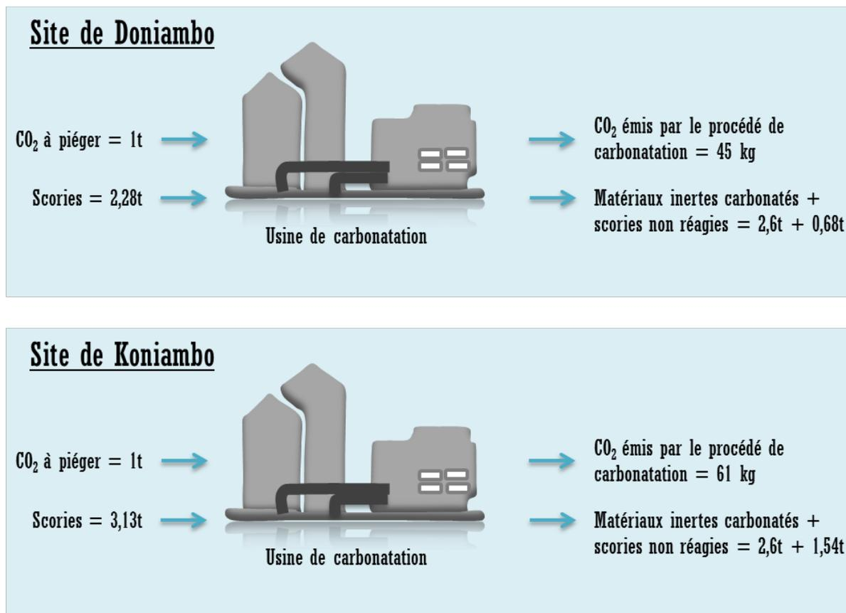
Figure 8 : Bilan matière et CO<sub>2</sub> d'une unité de carbonatation sur les sites pyrométallurgiques de Doniambo et Koniambo
