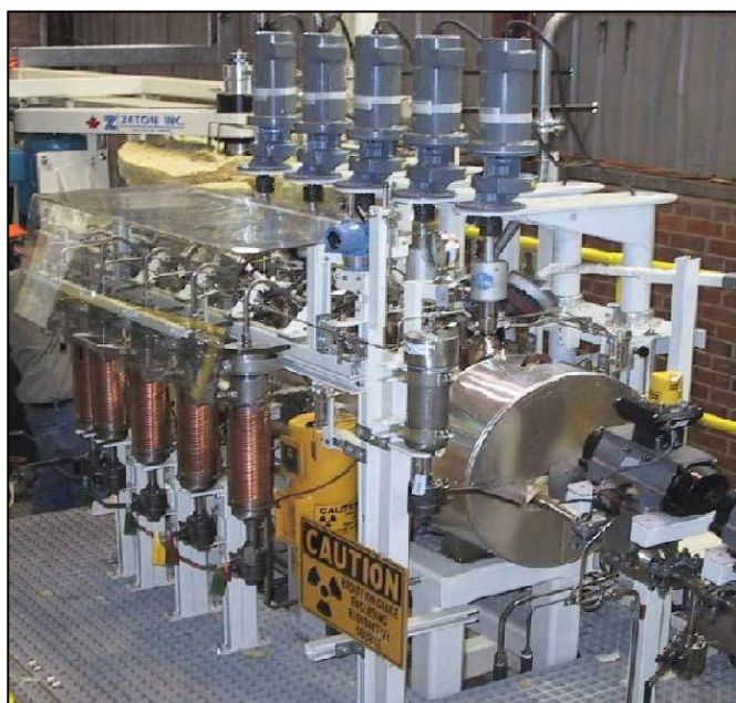
Figure 15 : Usine pilote HPAL utilisée par SGS Lakefield Oretest (Perth, Australie) pour traiter le minerai de Lucknow. (Metallica Minerals Ltd., 2012).
