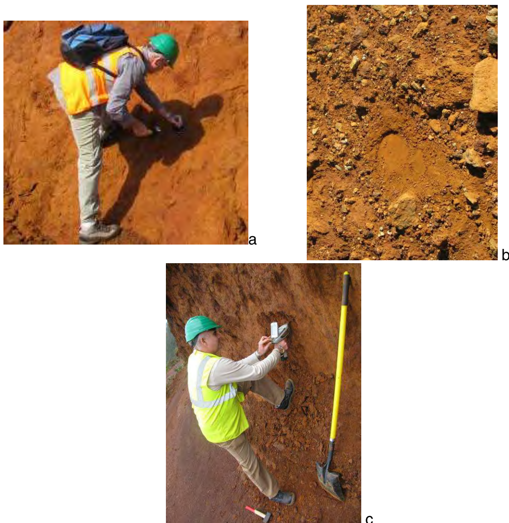
Illustration 82 : Préparation de la zone d'analyse (a) ; zone aplanie (b) et analyse par FPXRF de la zone (c).
