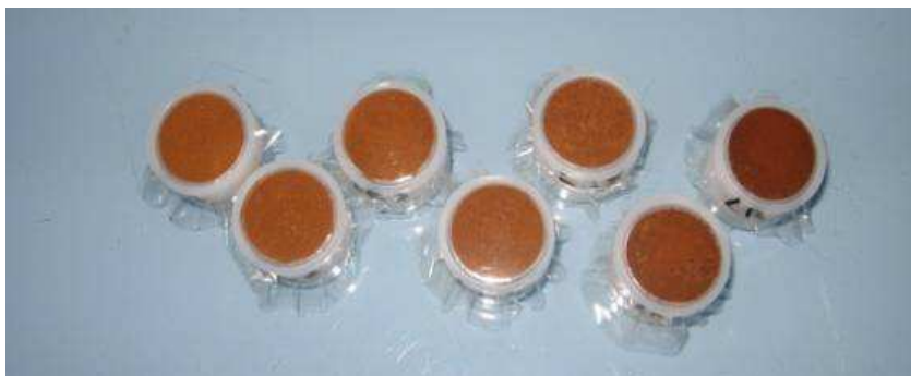
Illustration 55 : Préparation des échantillons de latérites dans des coupelles fermées recouvertes d'un film Mylar®.
