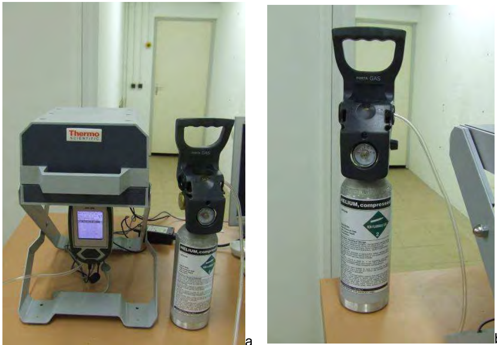
Illustration 11 : Utilisation du XL3t au laboratoire avec le support de pailleuse (a) et la bouteille d'hélium (b).
