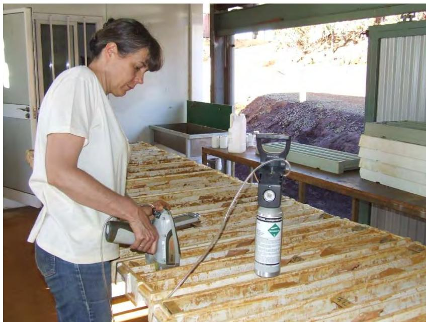
Illustration 40 : Analyse par FPXRF équipé d'une purge à l'hélium.
