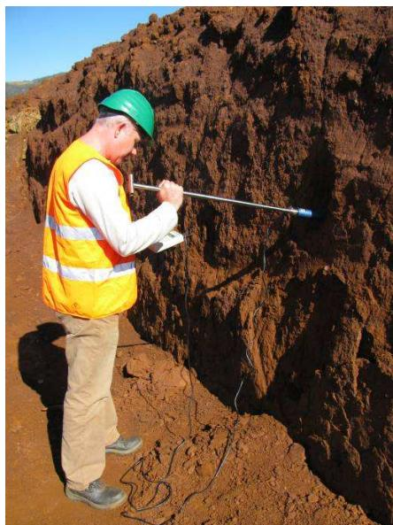
*Illustration 64 : Utilisation d'un humidimètre à broche sur front.*
