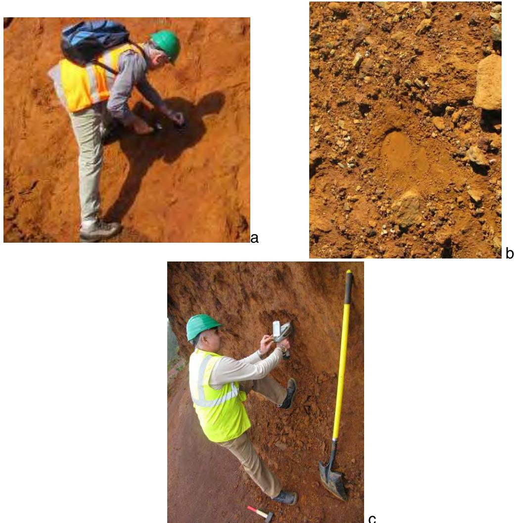
*Illustration 82 : Préparation de la zone d'analyse (a) ; zone aplanie (b) et analyse par FPXRF de la zone (c).*
