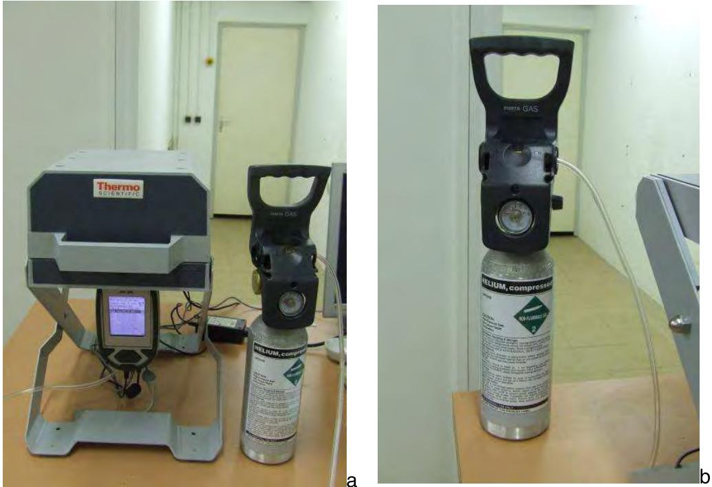
Illustration 11 : Utilisation du XL3t au laboratoire avec le support de paillasse (a) et la bouteille d'hélium (b).
