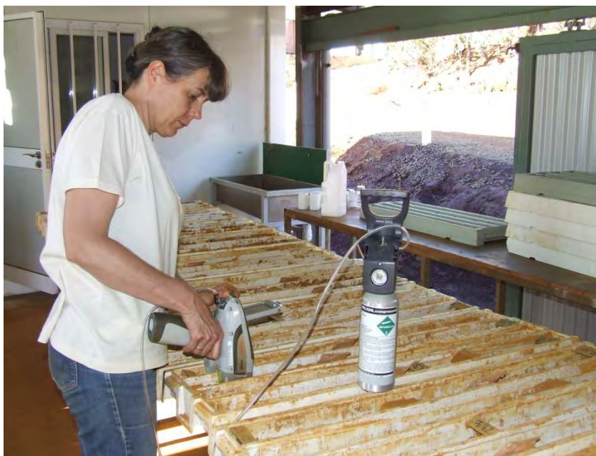
Illustration 40 : Analyse par FPXRF équipé d'une purge à l'hélium.
