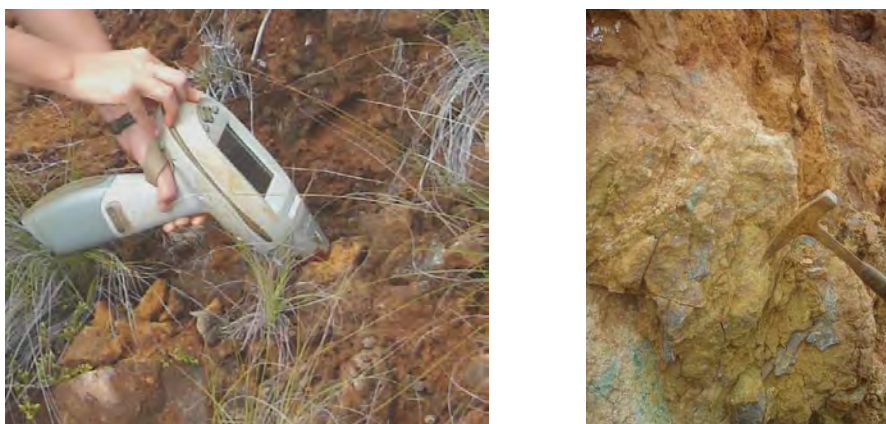
Illustration 97 : Analyse de zones indurées (photo de gauche source SLN).
