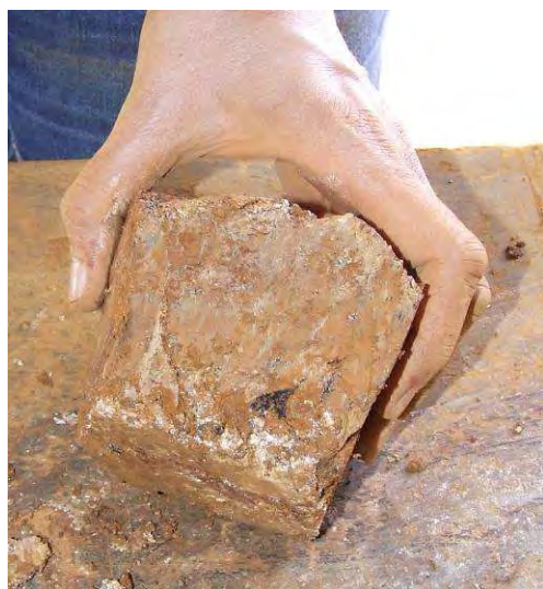
Bloc après taillage à la spatule
