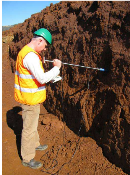
Illustration 64 : Utilisation d'un humidimètre à broche sur front.
