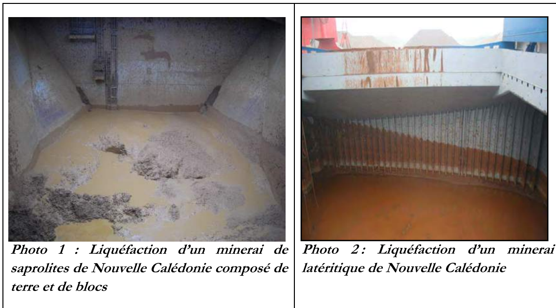
Figure 1 : Liquéfaction d'un minerai de saprolites composées de terre et de blocs et d'un minerai latéritique de Nouvelle Calédonie
