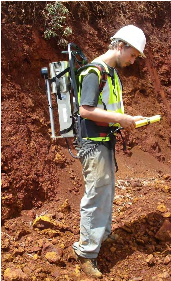
Figure 3 : Spectromètre PGIS21 en opération en Nouvelle-calédonie
