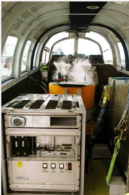
Figure 6 : Capteur Hymap et avion utilisé pour le survol
