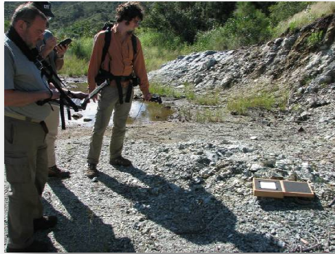
Figure 8 - Spectroradiomètre ASD FieldSpec® 3 et son utilisation en lumière naturelle en Nouvelle-Calédonie pour la cartographie de l'amiante.
