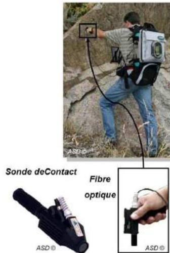
Figure 8 : Fibre optique et sonde de contact de l'ASD FieldSpec 3.
