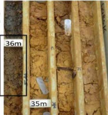
**Figure 51 : Vue du niveau enrichi en carbone et tableau récapitulatif des résultats des analyses de carbone total réalisées sur une sélection d'échantillons du profil S78 de Goro.**
