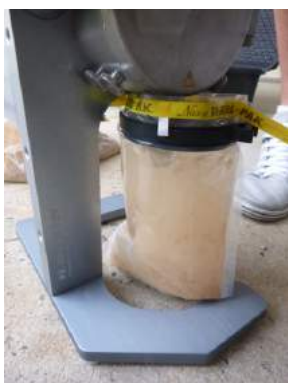
e) Récupération du matériel broyé
