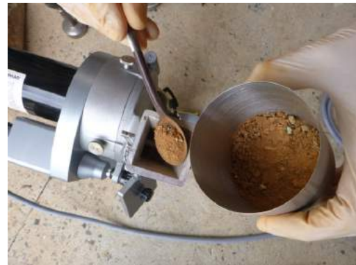
d) Alimentation du broyeur
