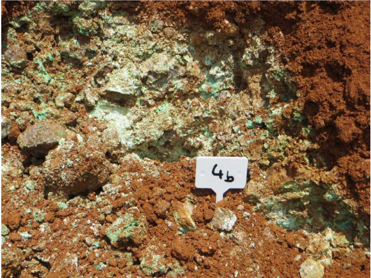
Figure 10 : Présence de Garnièrite à la base du front n°3
