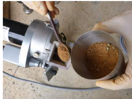
d) Alimentation du broyeur
