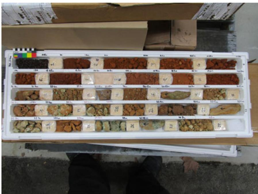
Figure 3 Echantillons dans des boites à carottes (ici JB2)
