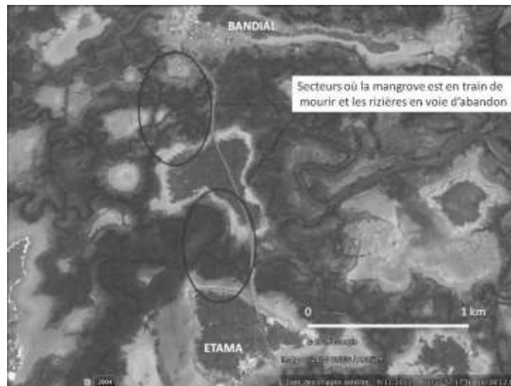
Figure 14 : extrait d'une image de Google Earth montrant les secteurs où mangrove et rizières sont en train de dépérir, la marée ne pouvant plus circuler en volume suffisant sous les ponts sous lesquels le volume transitant aux marées hautes est extrêmement réduit, la profondeur de l'eau passant de 5 à 6 mètres de part et d'autres à moins de 20 cm sous le pont (voir figure 13 gauche).
