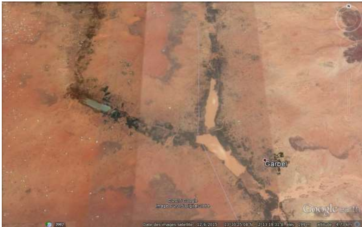
Figure 16 : une mare « noire » (bleue, à gauche), Bangou Bi (voir figure 10 ci-dessus), à 3 km au nord du bout de la piste de l'aéroport de Niamey, un affleurement de la nappe ; les deux grandes mares à droite sont plus basses, donc aussi essentiellement dues à l'affleurement de la nappe, mais étant situées dans une vallée plus grande, elles ont déjà collecté, ce 12 juin 2005, des eaux de ruissellement, faisant croire à une « bangou kirey » mare rouge temporaire d'hivernage.
