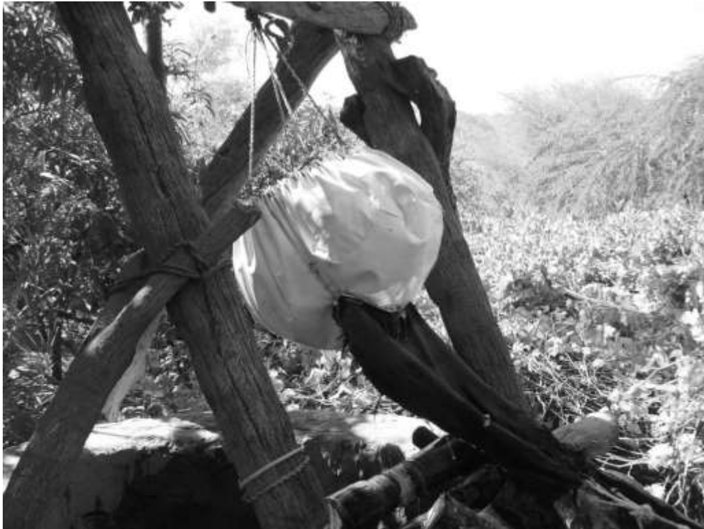
Figure 7 : mécanisme d'exhaure animal dans l'oasis de Timia (Aïr, Niger)
