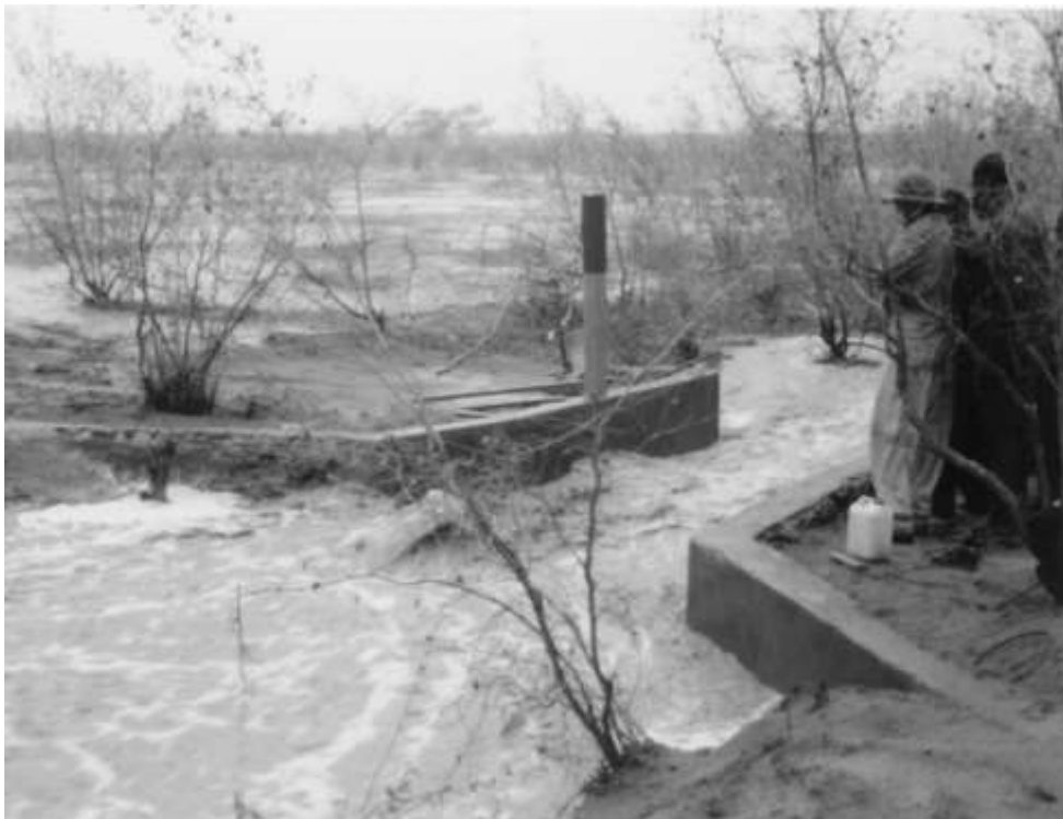
Figure 21. Crue du 30 avril 2004, bien avant le début de la mousson, sur la station Wankama AVZE alors en chantier ; le débit spécifique est fort du fait de l'absence totale d'activité végétale, comme pour les pluies de début de mousson ; ce jour là, 130 mm sont tombés dans la moitié nord de la ville de Niamey, causant d'énormes dégâts et des pertes humaines.
