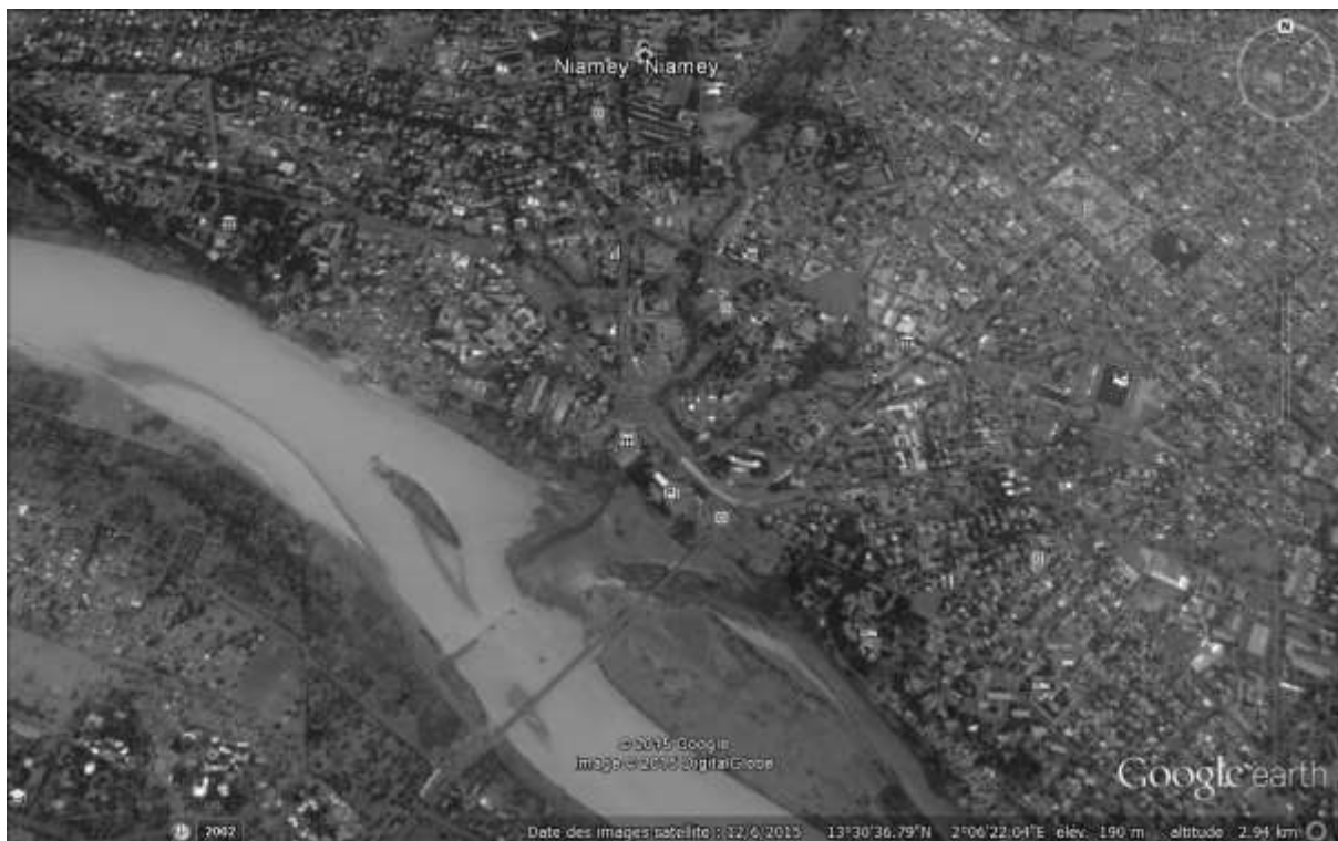
Figure 21 : cône de déjection du kori Gounti Yena (au centre) encombrant la moitié du lit du Niger à Niamey, ayant apporté les sédiments de son bassin essentiellement urbain, au ruissellement accéléré (voir aussi figure 26 chapitre 7)
