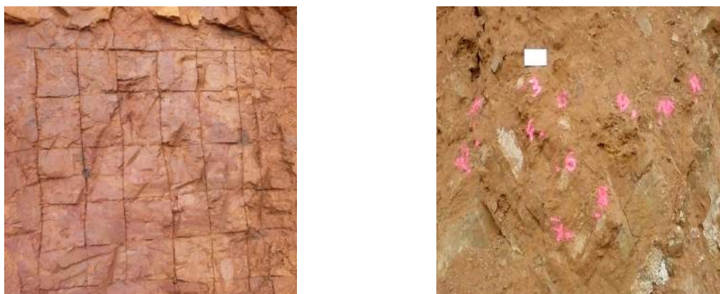
Figure 43 : Points d'échantillonnage en vue de la calibration des instruments (Grille à gauche et points aléatoires à droite)
