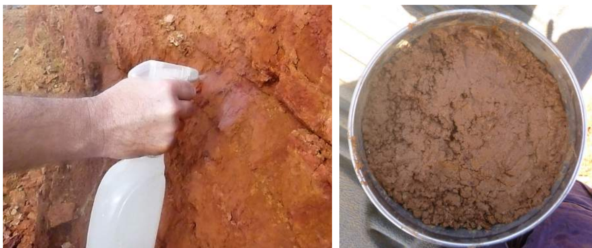
Figure 42 : Mise à saturation sur front, à gauche et dans un tamis, à droite
