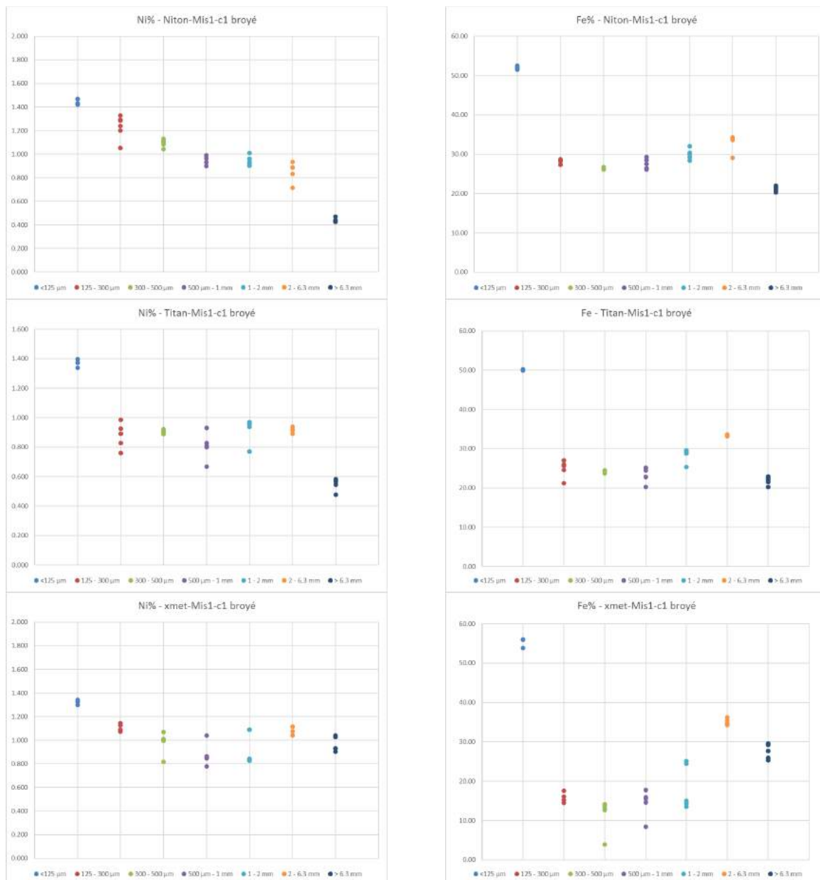
Figure 67 : Dispersion des teneurs mesurées en Ni et Fe – Echantillon MIS1-C1 broyé à 125 µm (Mesures aux Niton, Titan et XMET)
