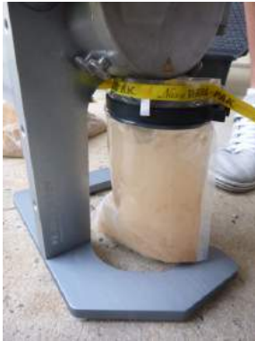
e) Récupération du matériel broyé
