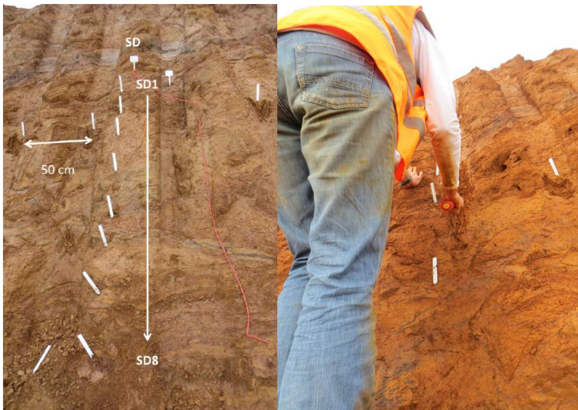
Figure 7 : Points de mesures (8) par pXRF le long de la saignée puis prélèvement par grappillage le long de la saignée du front n°1
