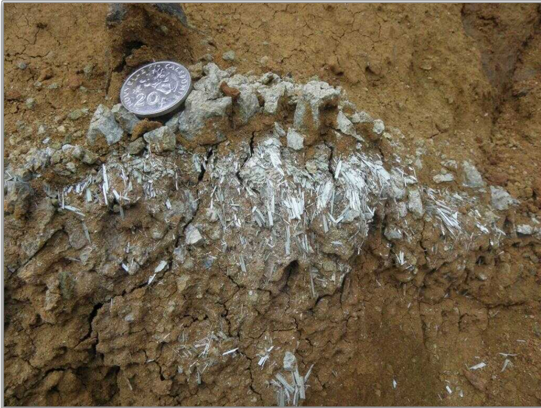
Illustration 117 : Plan à trémolite fibreuse, très altéré, localisé au niveau d'une éponte d'un filon de microgabbro (Route de Saint-Gabriel).
