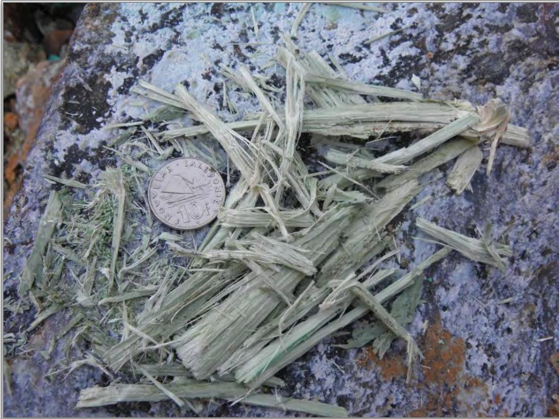
*Illustration 113 : Faisceaux fibreux verdâtres issus d'un plan à trémolite (Poro).*
