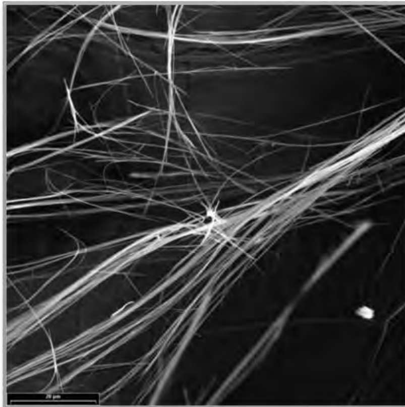
Illustration 128 : Image MEB de fibres très fines et courbes de trémolite issues d'un plan fibreux très altéré (barre d'échelle = 20 \mu\text{m} ) (Kopéto).
