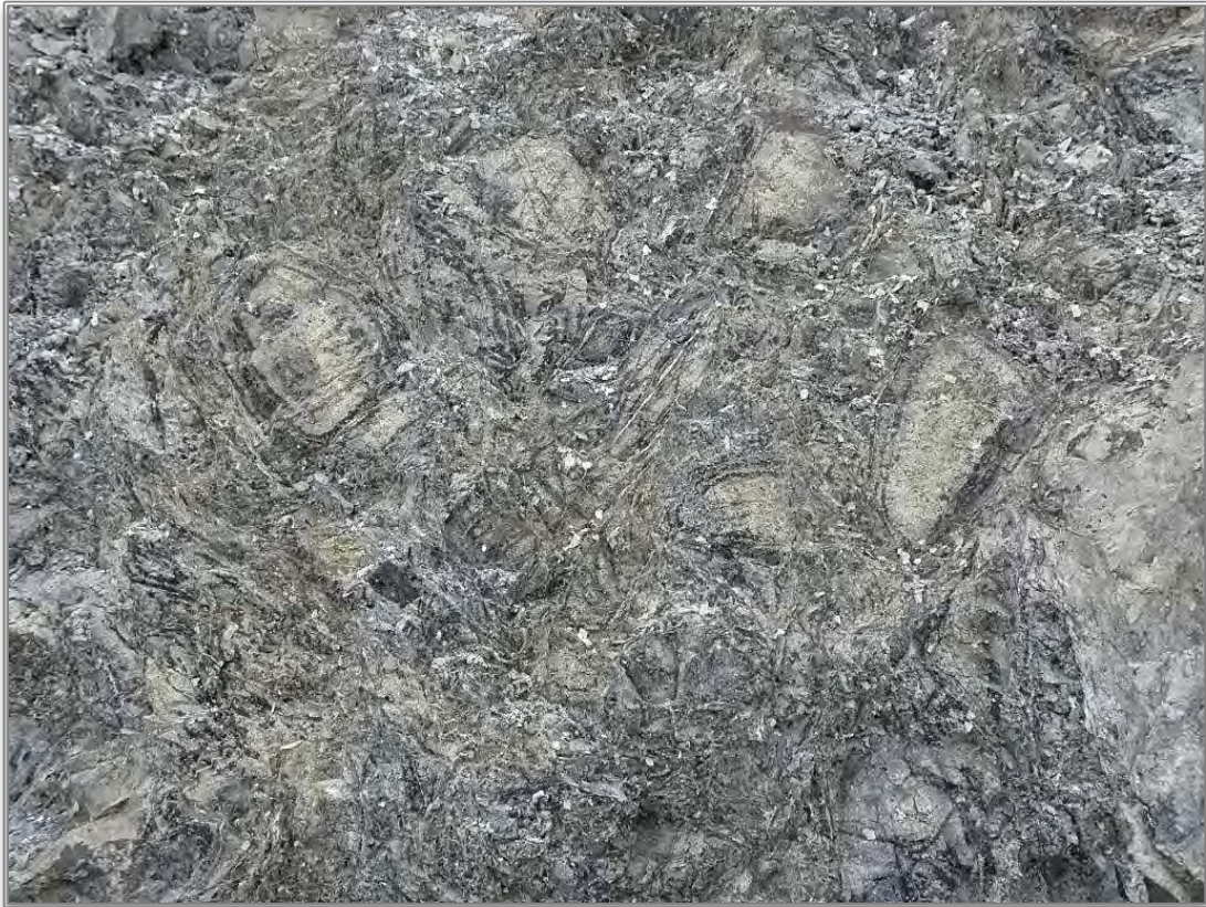
Illustration 44 : Aspect du talus montrant des nodules hétérométriques de péridotites serpentinisées emballés dans une matrice serpentineuse écrasée et cataclastique.
