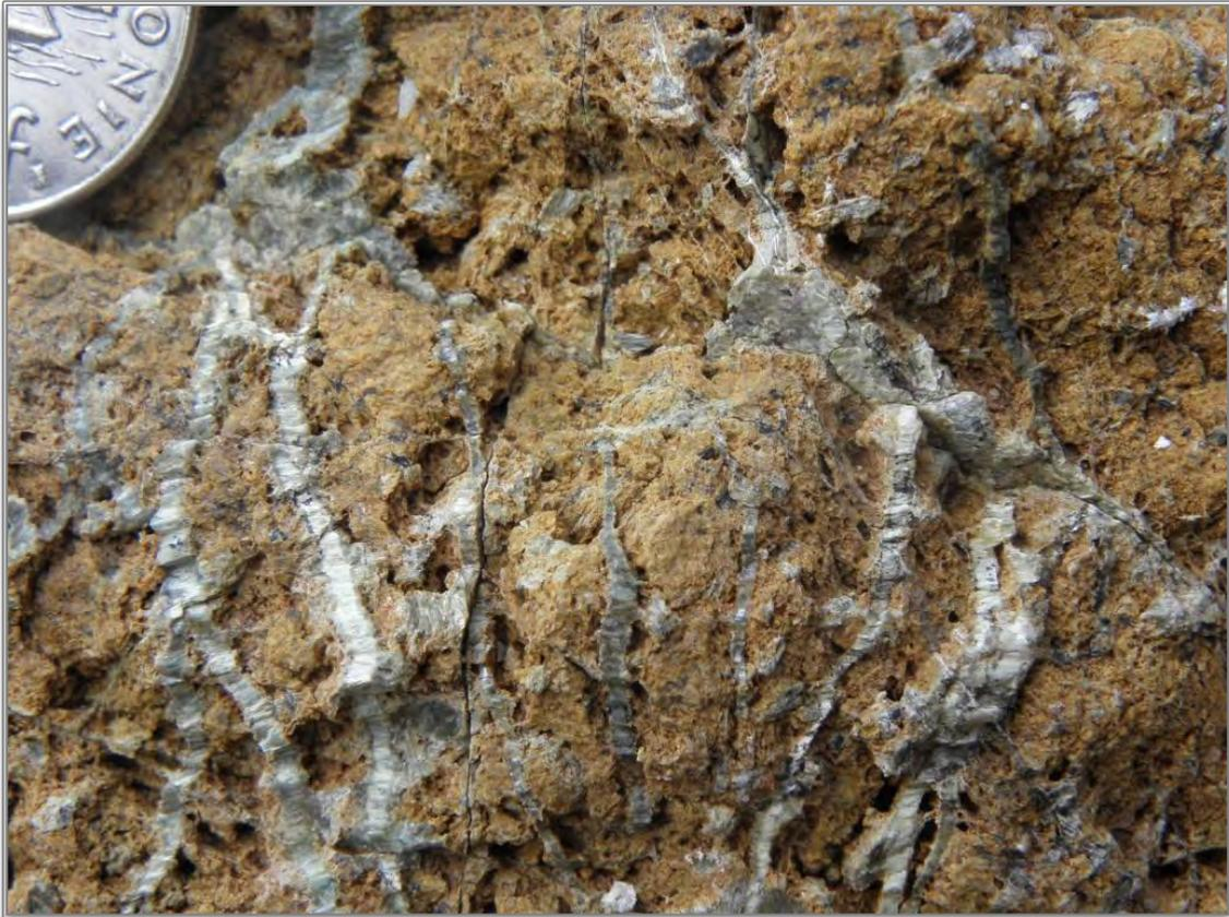
*Illustration 70 : Réseau de veines à trémolite fibreuse recoupant les péridotites (Porro).*
