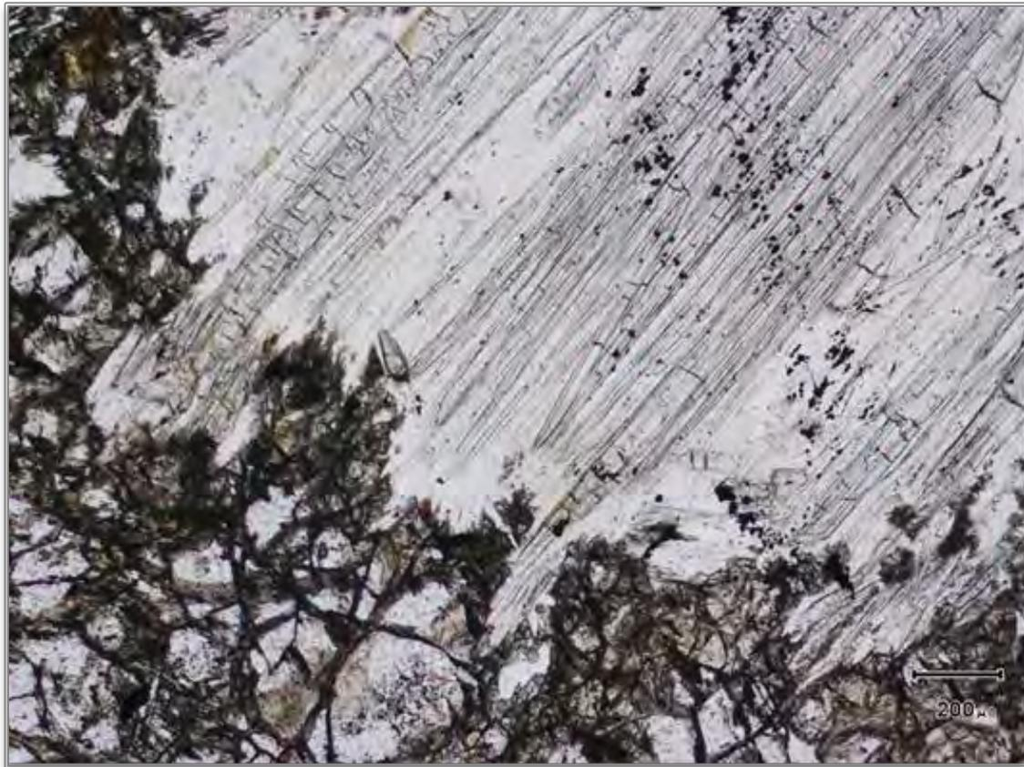
*Illustration 76 : Contact entre une péridotite (bas) et une veine à trémolite fibreuse (haut) (Poro).*
