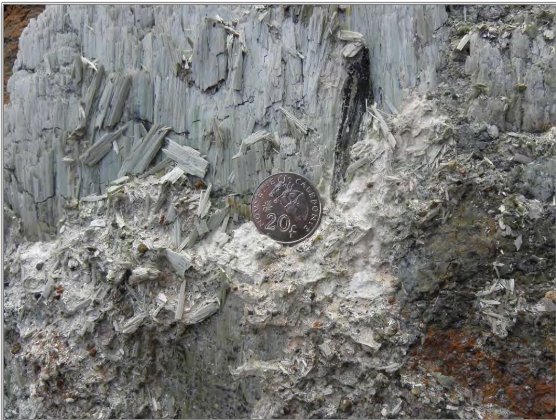
Illustration 100 : Amas de particules fibreuses fines issu de l'altération d'un plan à antigorite (Mine de Vulcain).
