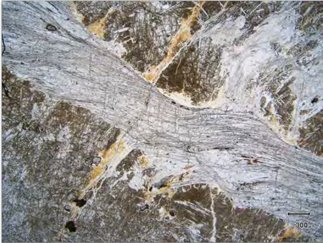
Illustration 72 : Veine à trémolite fibreuse recoupant une péridotite peu serpentinisée (Poro).
