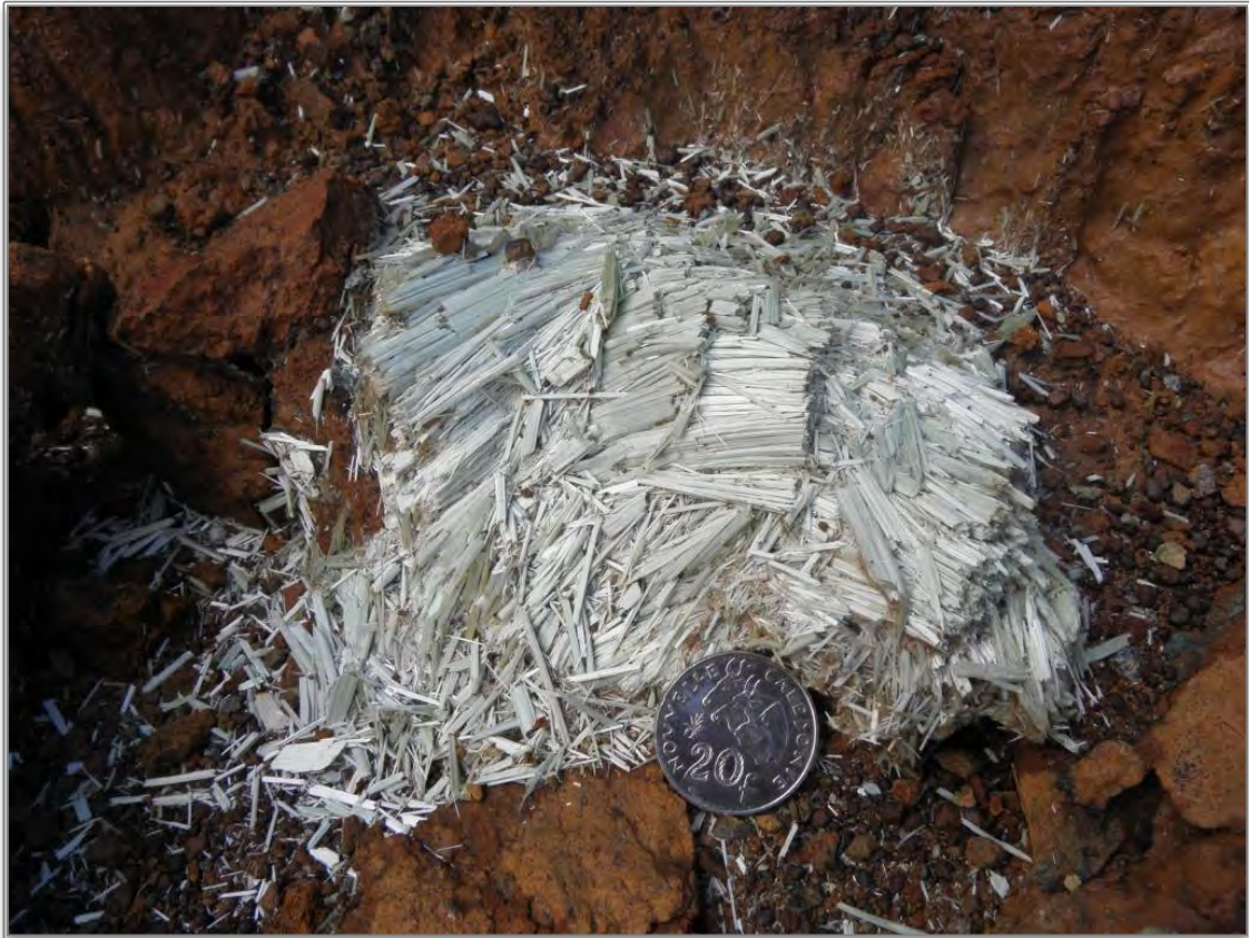
Illustration 99 : Amas fibro-lamellaire peu altéré, en cours de désintégration (Mine de Vulcain).
