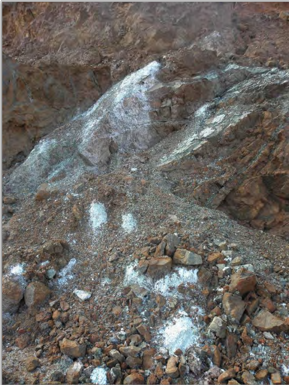
Illustration 98 : Amas fibro-lamellaires blanchâtres observés en pied de talus (Mine de Vulcain).
