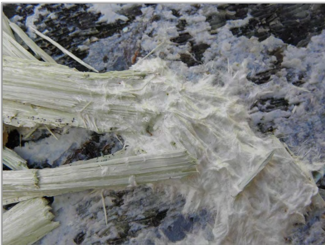
Illustration 114 : Terminaisons de faisceaux altérés de trémolite, présentant un aspect souple et « cotonneux » (Poro).
