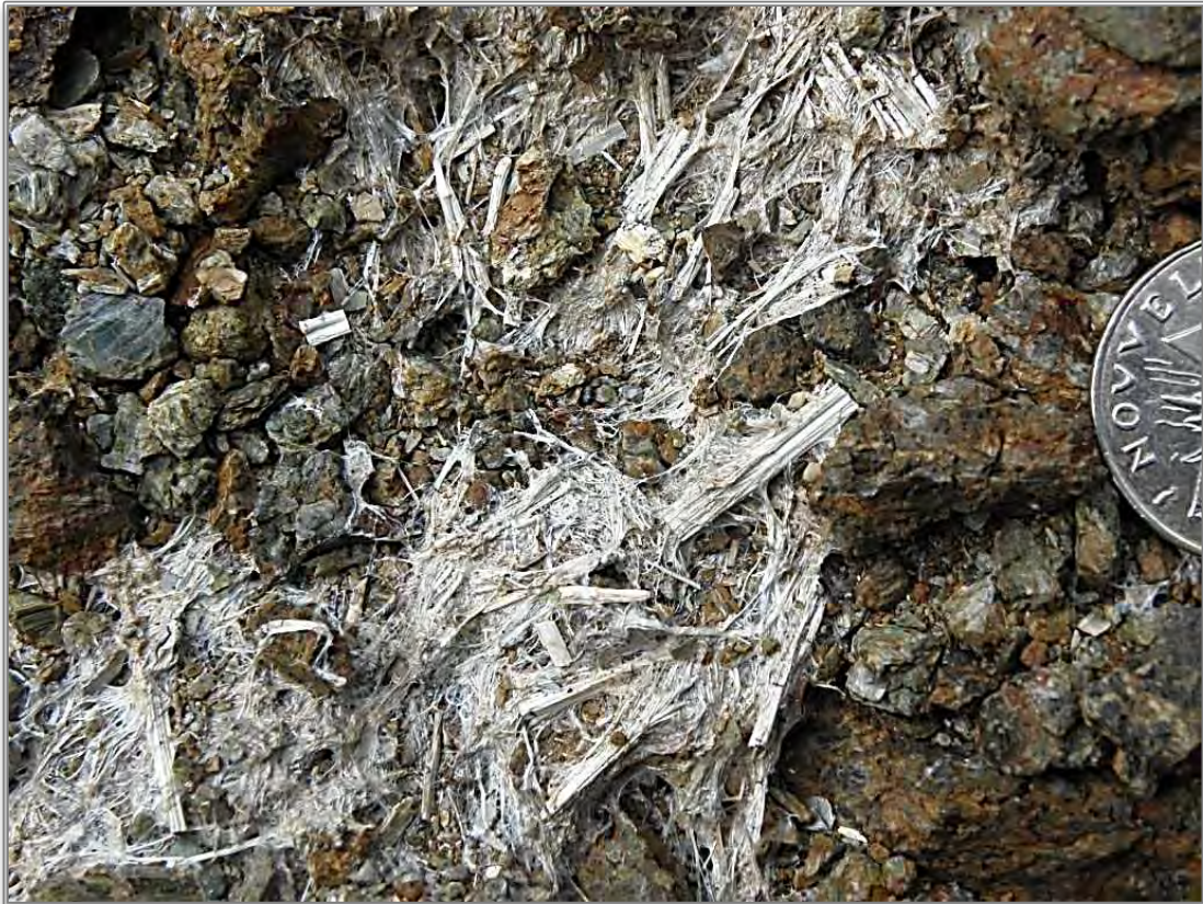
Illustration 92 : Amas de faisceaux fibreux rigides et de fibres souples d'anthophyllite (Mine de Vulcain).
