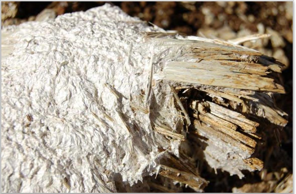
*Illustration 112 : Amas de fibres rigides et de fibres souples « cotonneuses » (Koniambo).*
