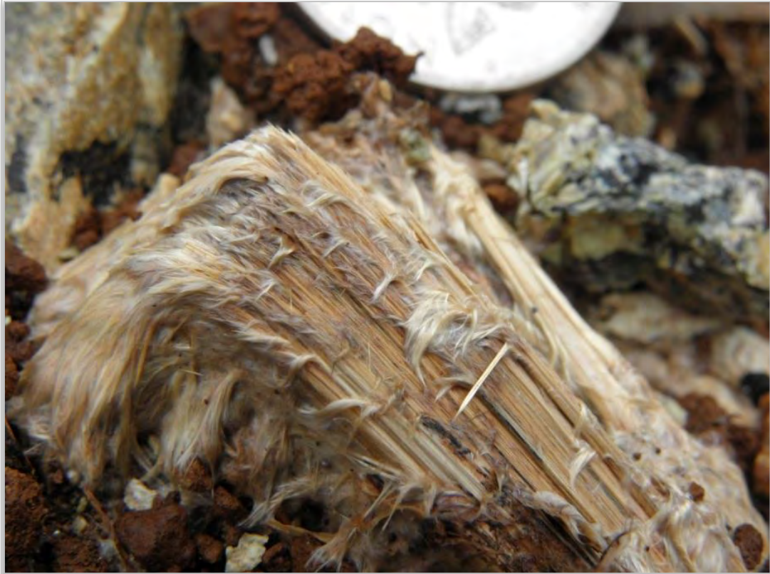
Illustration 115 : Faisceau fibreux de trémolite, montrant une terminaison en «plumeau » (Massif du Sud).
