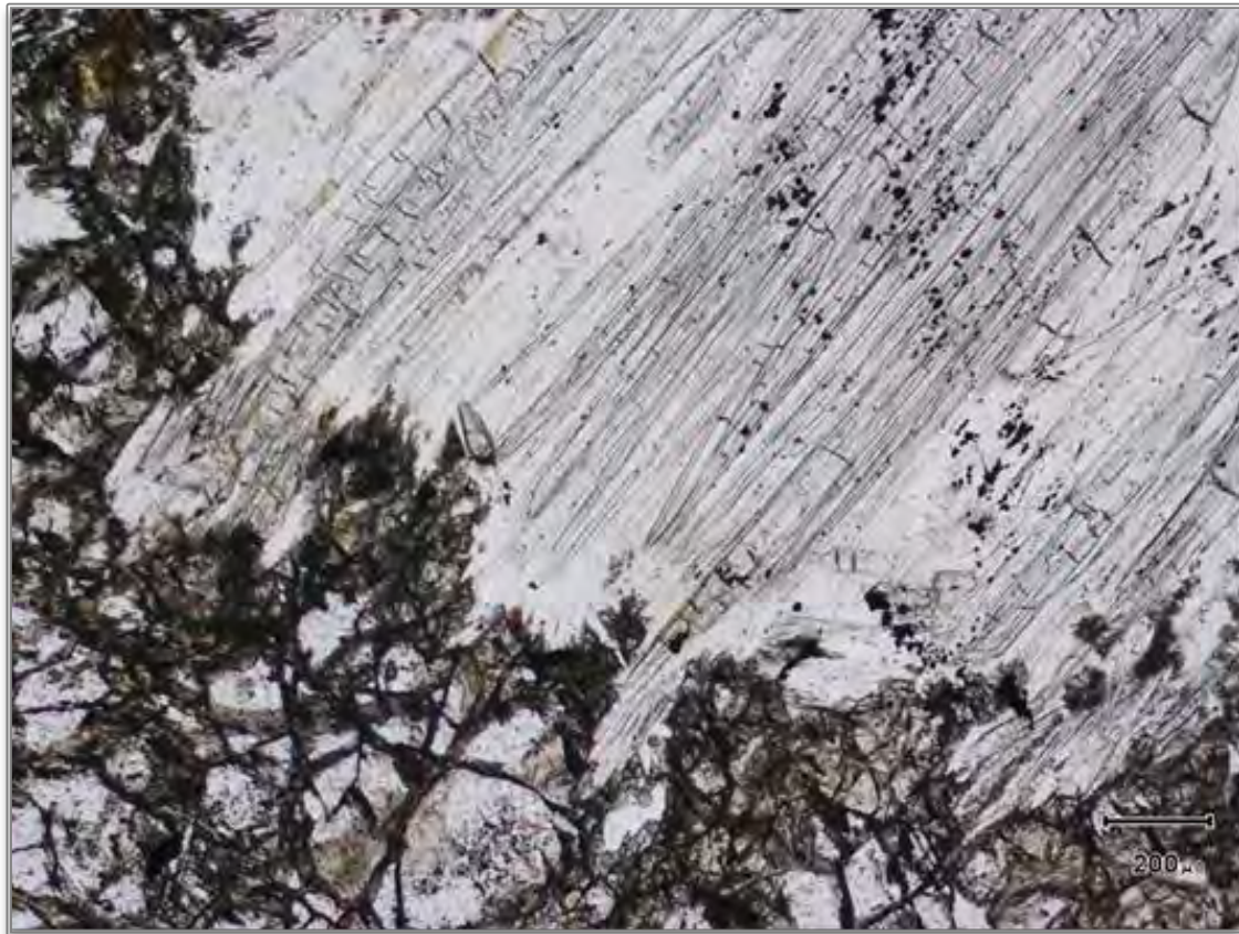
Illustration 76 : Contact entre une péridotite (bas) et une veine à trémolite fibreuse (haut) (Poru).
