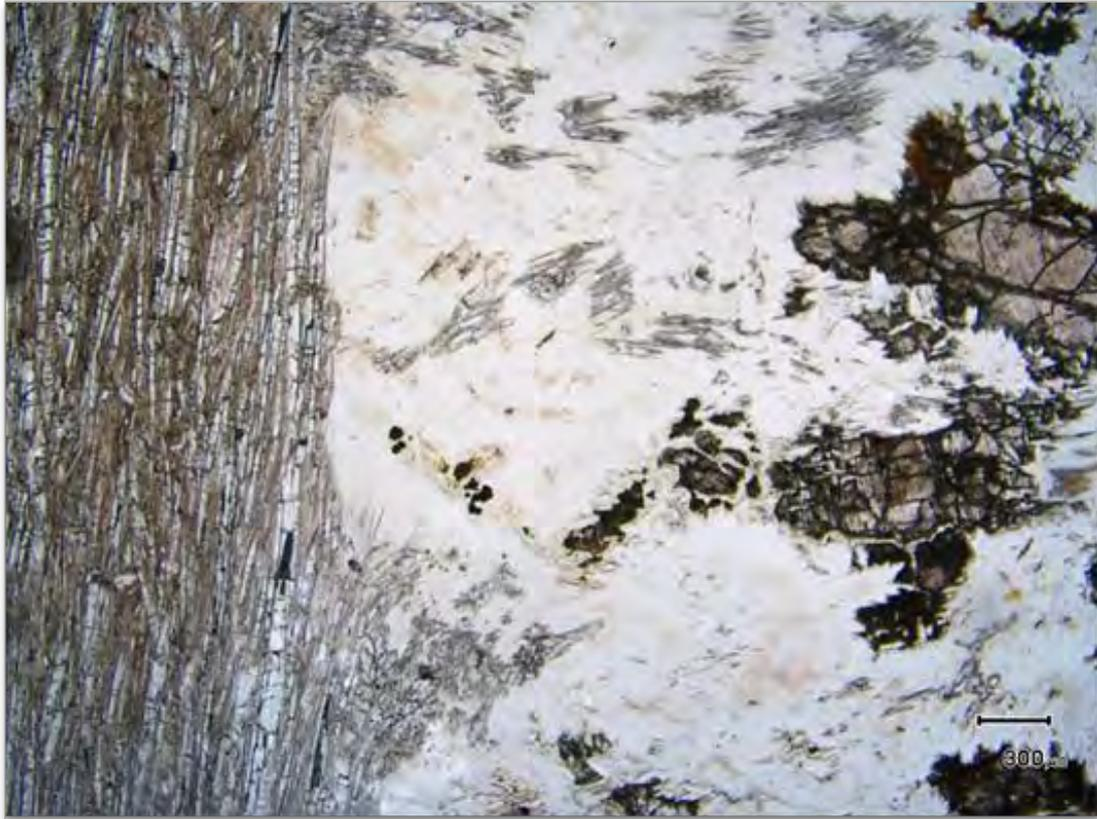
*Illustration 74 : Contact entre une péridotite serpentinisée (droite) et une veine de trémolite (gauche) (Poro).*
