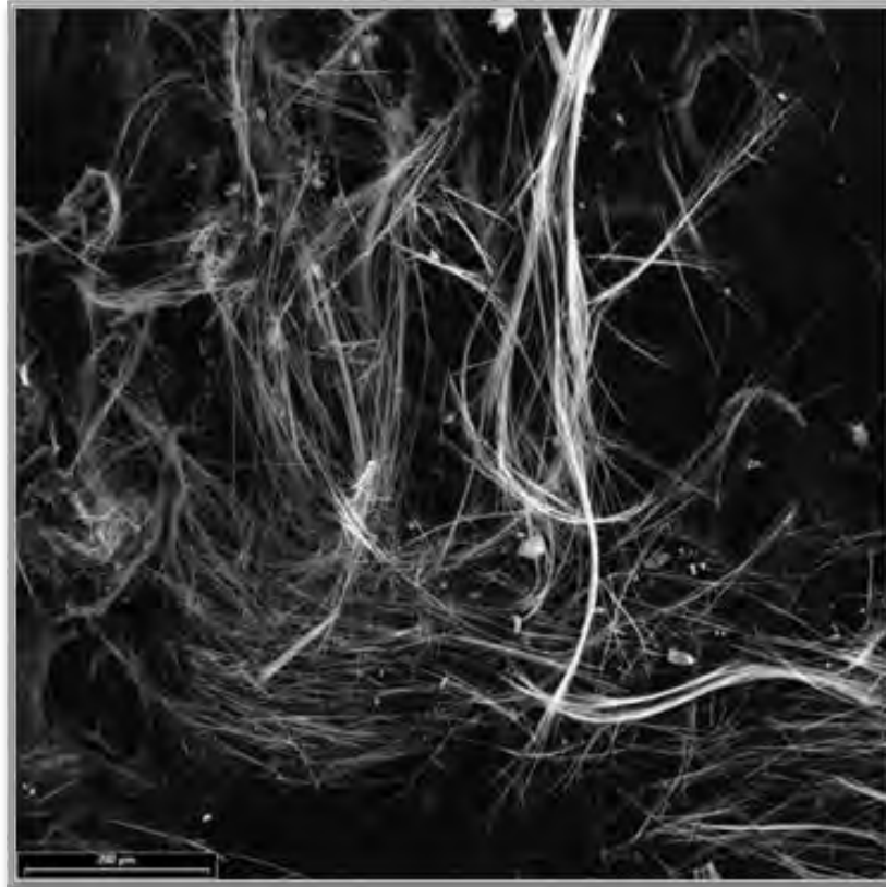
Illustration 78 : Image MEB de longs faisceaux courbes de trémolite prélevés sur un plan fibreux infra-millimétrique (Koniambo).
