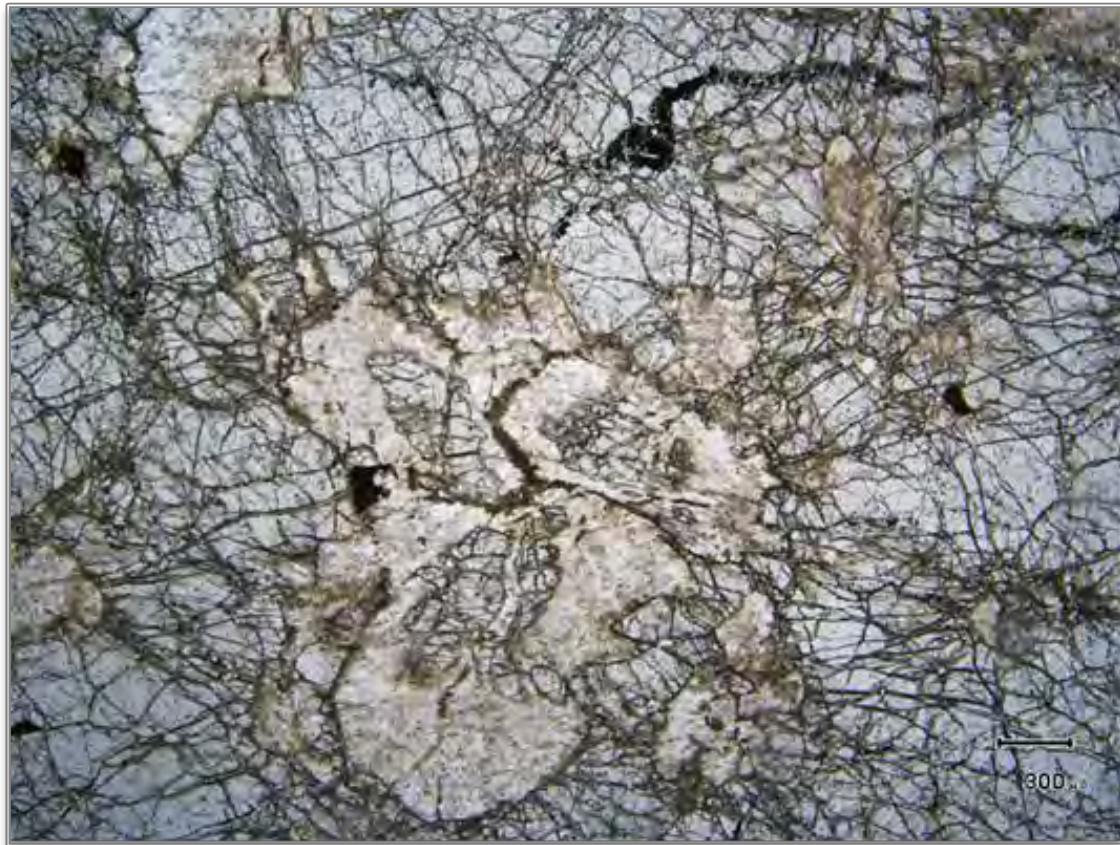
Illustration 12 : Harzburgite à pseudomorphoses à talc + trémolite (Porosity).
