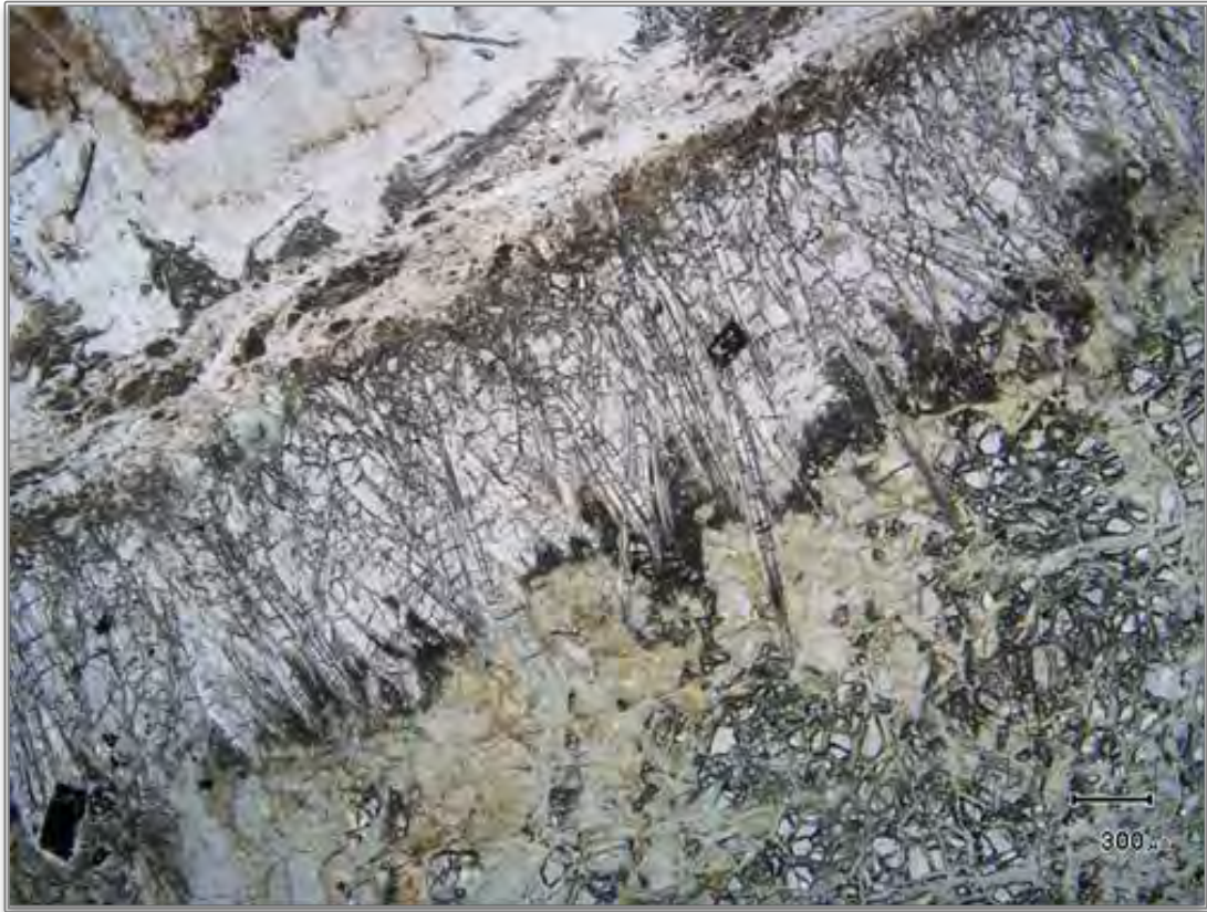
Illustration 88 : Contact entre une péridotite serpentinisée (bas) et une veine à serpentine-chlorite-anthophyllite (haut) souligné par cristallisations d'anthophyllite prismatiques (Tiebaghi).
