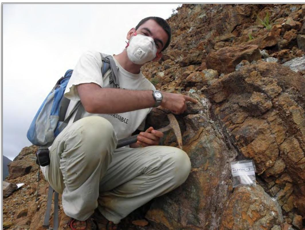
*Illustration 69 : Plan amiantifère altéré parallèle à des fissures soulignées par des cristallisations de chlorite magnésienne (Massif de Porro).*
