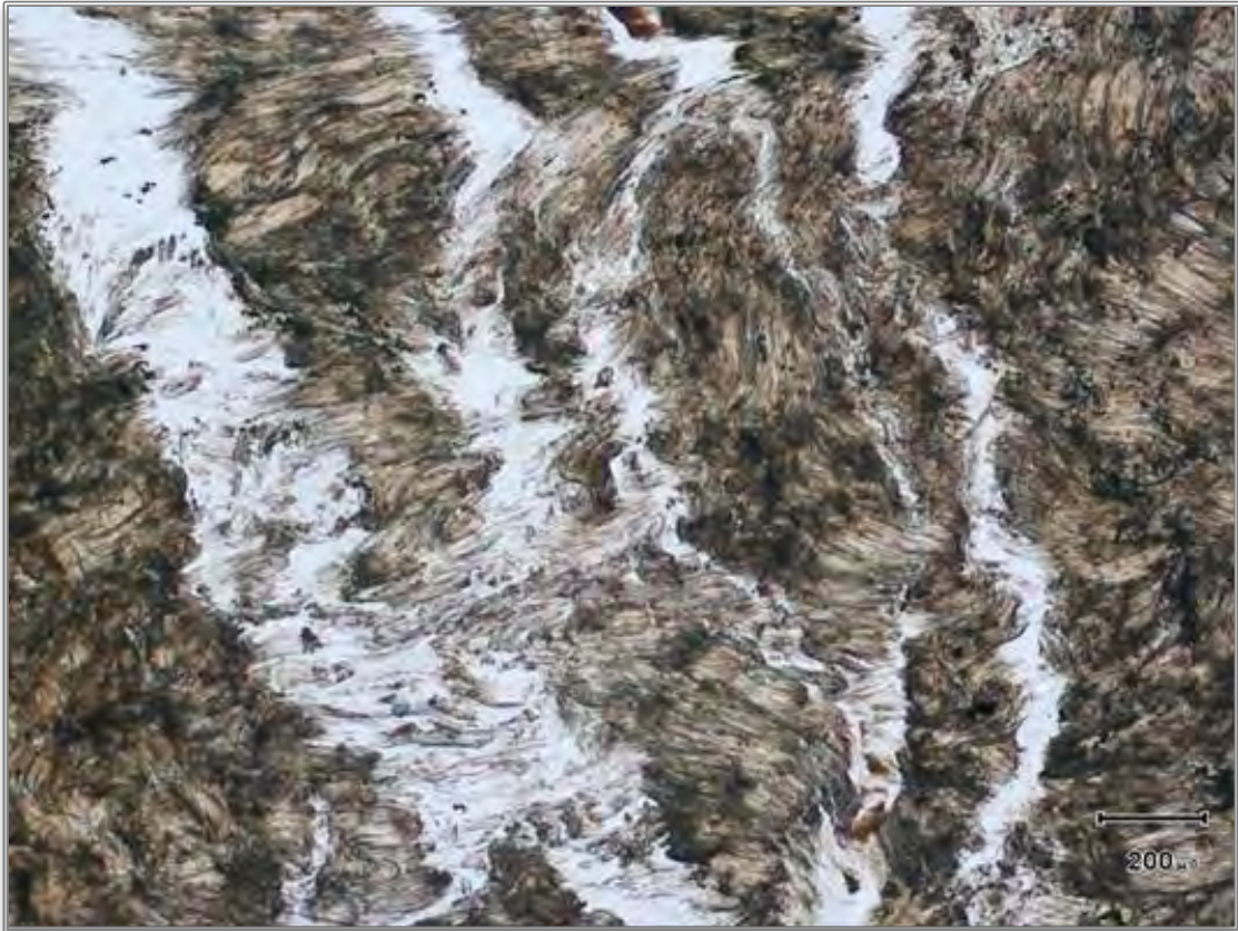
Illustration 38 : Aspect d'une grosse veine à chrysotile au microscope optique (Poru).
