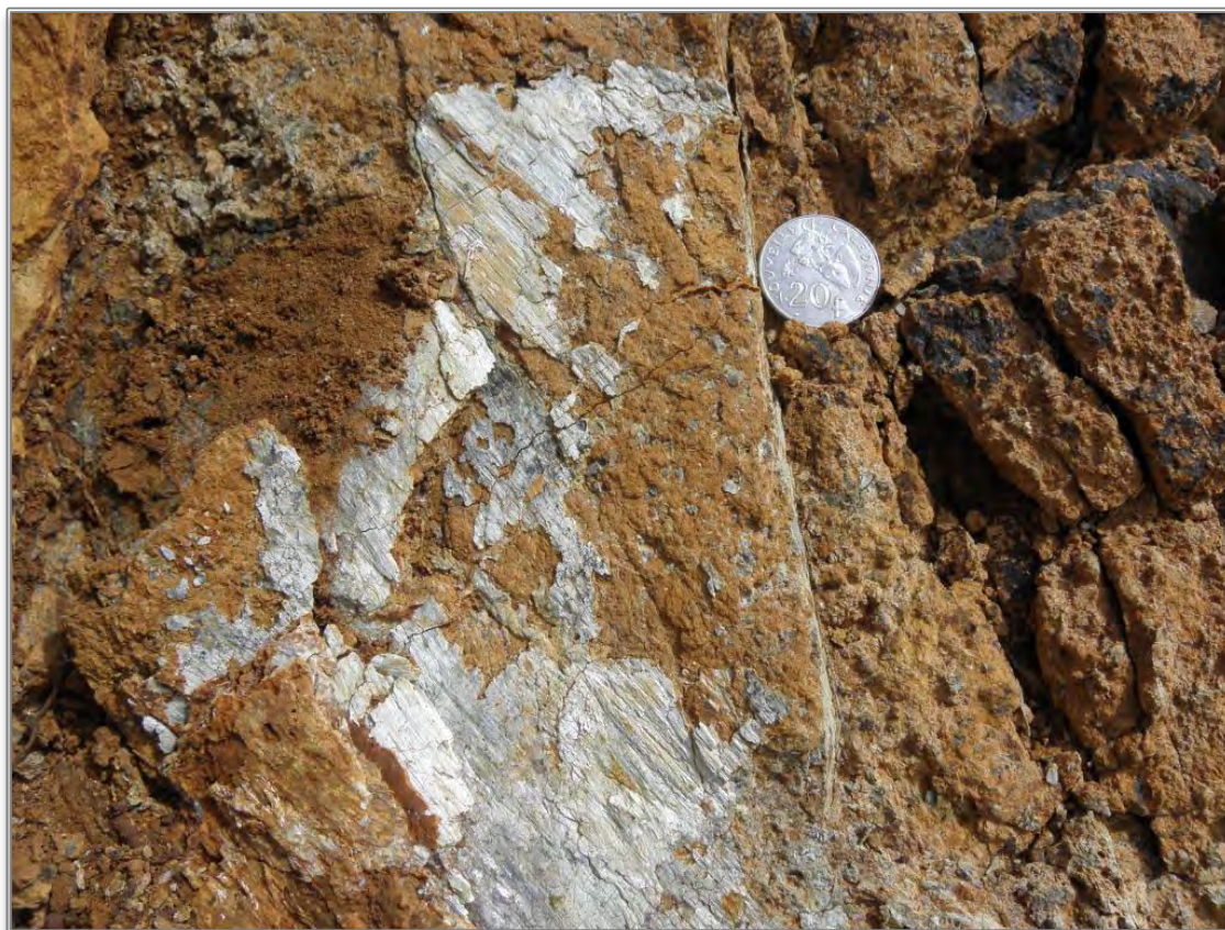
Illustration 65 : Plan fibreux à trémolite recoupant des harzburgites (Koniambo).
