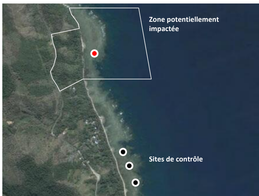
Figure 9 : positionnement des points d'échantillonnage d'un BACIPS avec un point dans la zone subissant la pression, et trois points de contrôle dans la zone ne risquant pas d'être impactée (zone aux caractéristiques géomorphologiques et courantologiques proches de la zone d'impact, pour éviter les facteurs de confusion).
