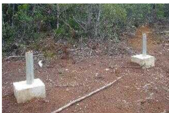
Figure 27 : Plateforme piézométrique (Massif de Goro) (source Golder)
