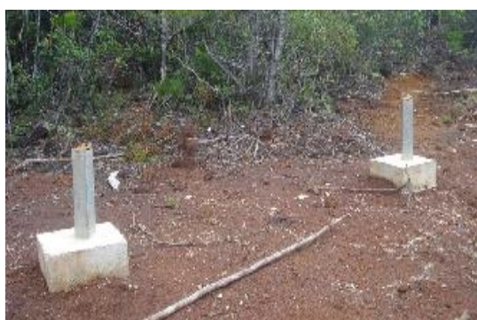
Figure 27 : Plateforme piézométrique (Massif de Goro) (source Golder)
