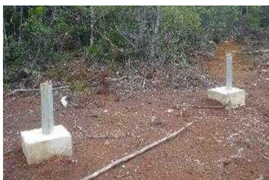
Figure 27 : Plateforme piézométrique (Massif de Goro) (source Golder)
