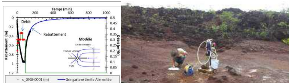
Figure 16: Pompage d'essai sur un piézomètre (Massif de Goro) (cliché source JL. Join)
