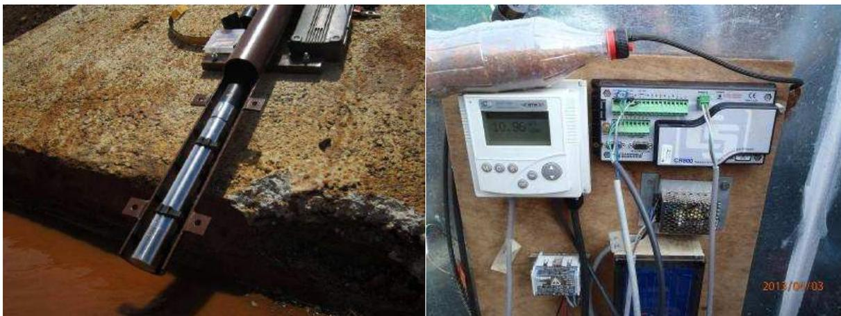
Installation de la sonde optique dans une goulotte      Boitier ViSolid et centrale Campbell
