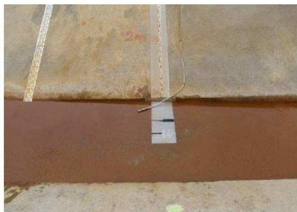
Station Poro aval avec capteur Doppler en place
