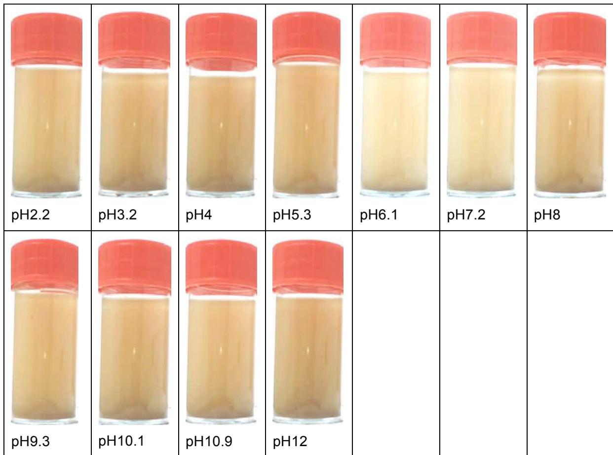
**Figure 24 : Image des échantillons AM21 à 80 s pour différents pH**
