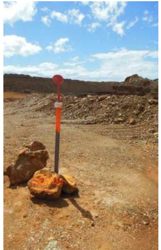
FIGURE 8 : EQUIPEMENT D'UN TROU NU POUR LE SUIVI PIEZOMETRIQUE PIEZOMETRE ISA03
