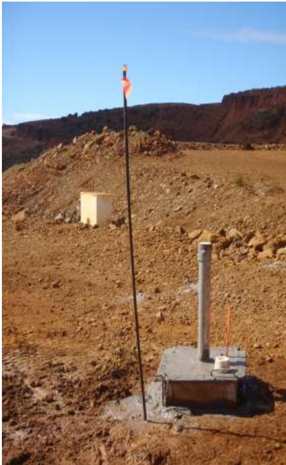
Parmi ces deux forages, un piézomètre a été réalisé dans le cadre du projet (figure 7), il est situé à quelques mètres du seuil amont. Ce forage réalisé par la SLN (nommé ISA17) a fait l'objet d'un équipement piézométrique spécifique financé à hauteur de 4K€ par le programme sur le volet financement Géosciences du PPME. Il est profond de 12,9 m (par rapport au tubage métallique), et la crépine de 6m capte le niveau des saprolites.
