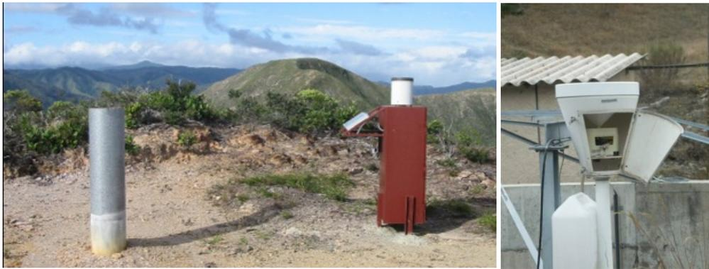
**Poró amont : pluviographe DAVAR équipé d'une transmission GSM (à droite) et pluviomètre totalisateur (à gauche)**
