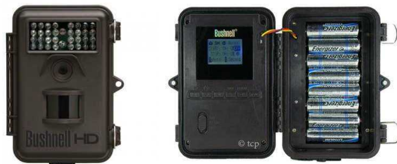
Figure 16 : Photos de la Caméra de Surveillance Numérique
