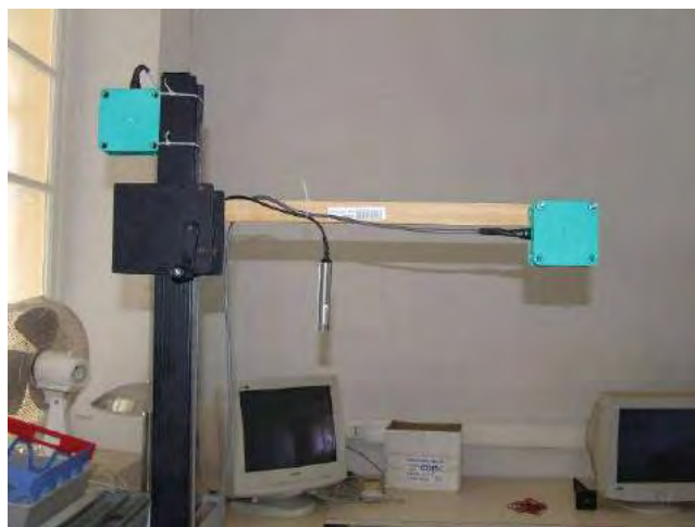
Figure 14 : Calibration des sondes à ultrasons
