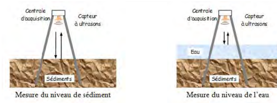
Figure 3 : Mesure des niveaux eau/sédiment
