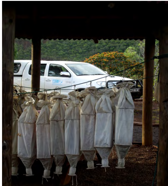
Figure 18 : Extraction de l'entomofaune à l'aide des sacs de « Winkler »
