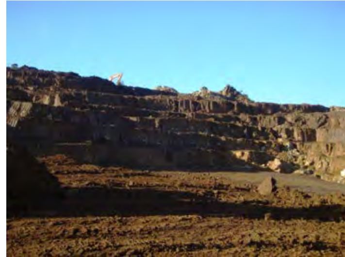
Gradins d'exploitation de la latérite.
