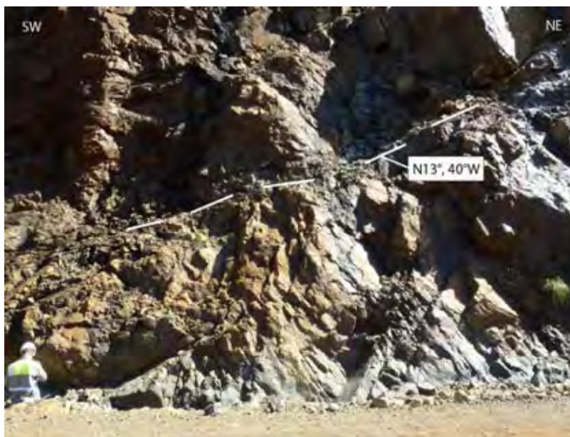
Figure 61 : Massif de Poro, mine La Française, piste minière. Structure « plate » et bréchique affectant la base du massif. Les péridotites présentent un faciès très serpentinisé.
