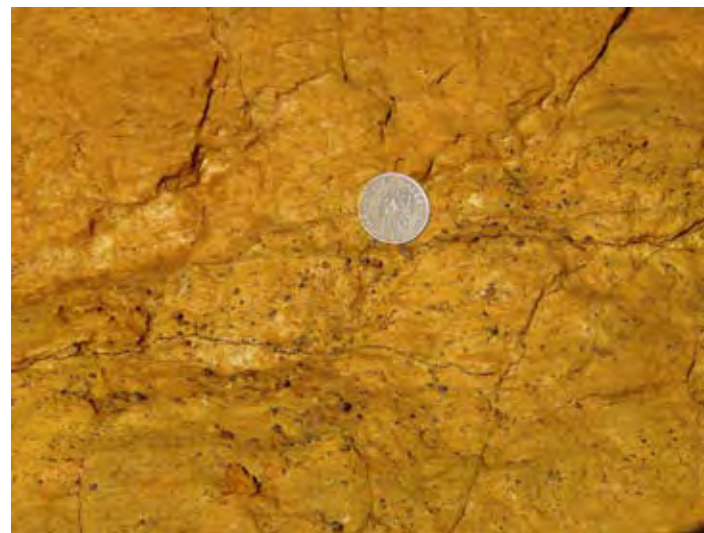
Niveau enrichi en chromite dans latérite jaune.
