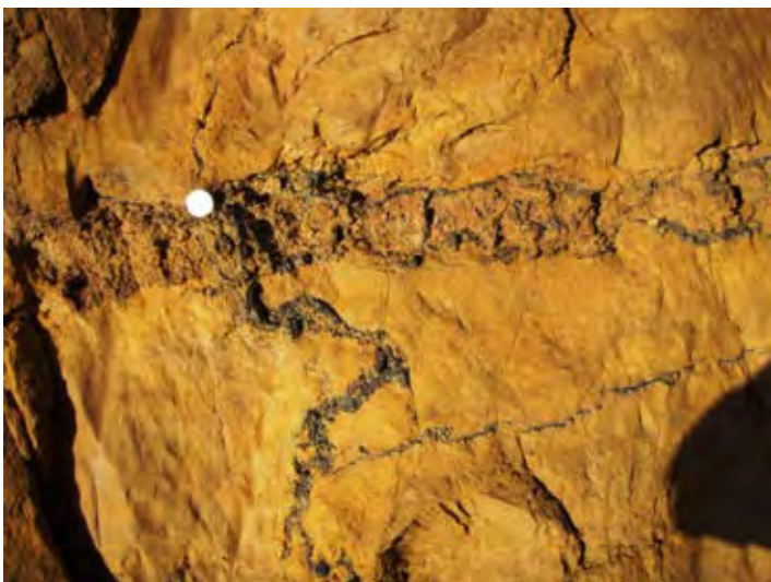
Détail de l'altération des veines (lithiophorite – gibbsite)
