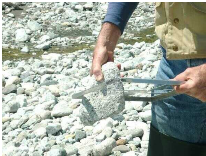
Figure 5 : Mesure de la taille d'un caillou
