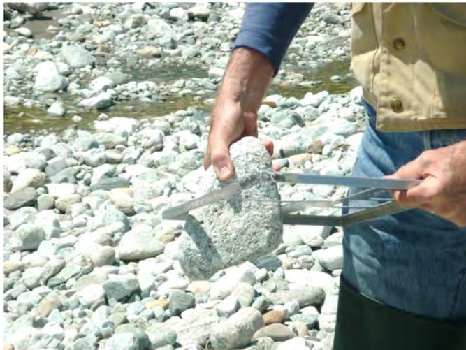
Figure 5 : Mesure de la taille d'un caillou
