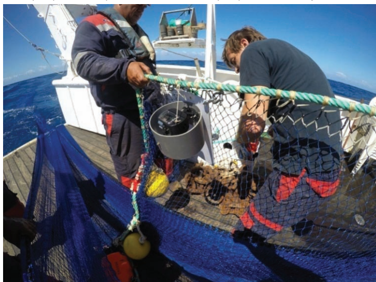
Installation du support et du caisson de la caméra sur le chalut pour tester l'étanchéité. Setting up the underwater house of the camera on the trawl to test if it is waterproof.
