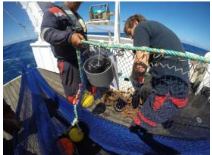
Installation du support et du caisson de la camera sur le chalut pour tester l'étanchéité.
