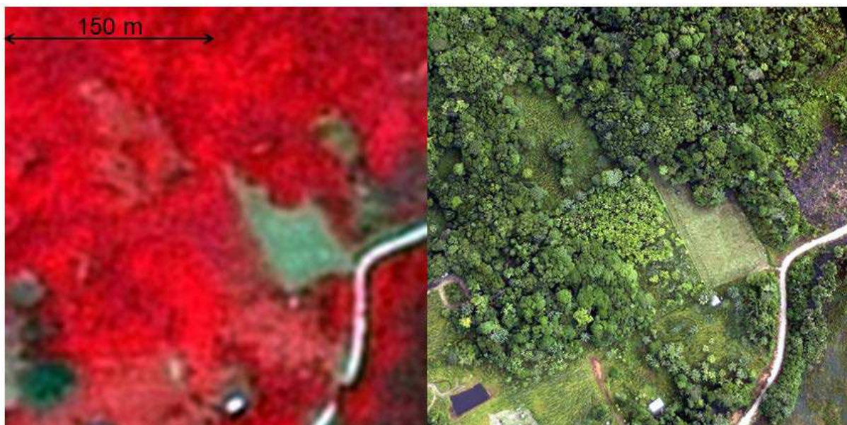
Figure 25: Mosaique de textures dans une région guyanaise. À gauche: image SPOT-5 en mode fusion (pixels de 2.5m, mais résolution autour de 4 m). À droite: une photographie de l'Avion Jaune (pixels de 20 cm environ). Adapté de Proisy et al. 2012.
