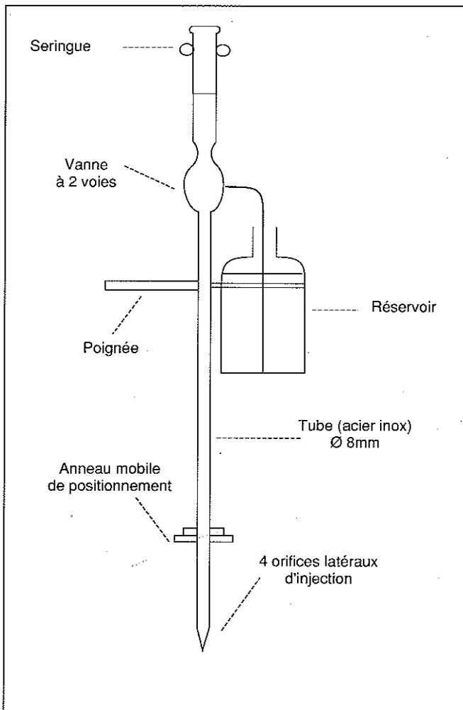
FIGURE 3 : Dispositif d'injection d'urée.
